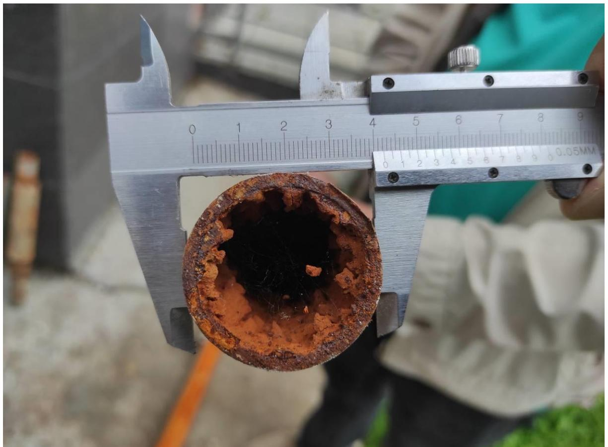
**Фото 22.** Замер диаметра трубопровода ГВС 42,3 мм. Коррозия внутренних стенок трубы
