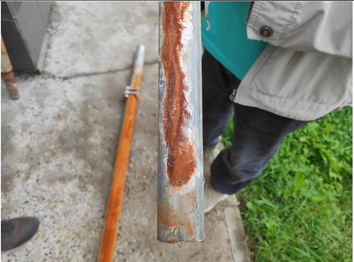
**Фото 21.** Фрагмент трубопровода ГВС. Повреждение оцинкованного слоя, коррозия наружных стенок трубы
