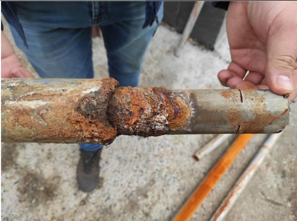
**Фото 23.** Демонтированный участок трубопровода с компенсатором. Коррозия, разрушение элементов
