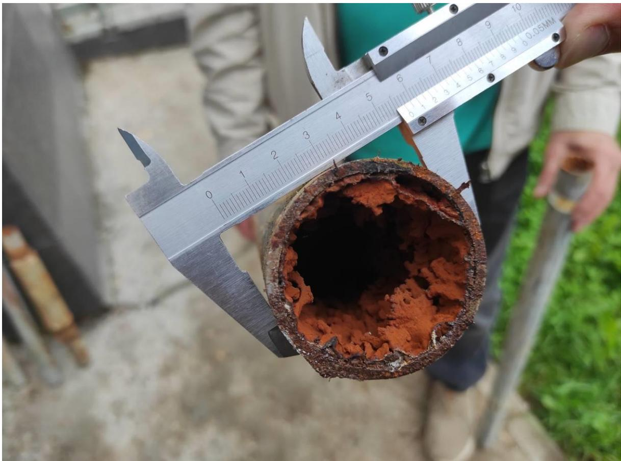
**Фото 20.** Замер диаметра трубопровода ГВС 57 мм. Коррозия внутренних стенок трубы
